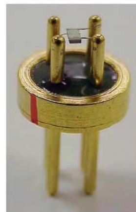
Slika 1. Senzor u čvrstom stanju za detekciju više od sto toksičnih gasova
