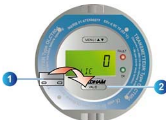
Slika 10: Postavljanje magneta na VALID poziciju omogućuje pristup meniju.
