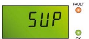
Slika 26: Očitavanje na displeju kada je eksploziometrijski detektor izložen visokim koncentracijama.
