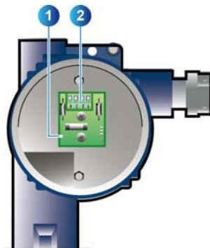
Slika 4: Unutrašnji pogled u detektor, bez prikazanog bloka displeja.
