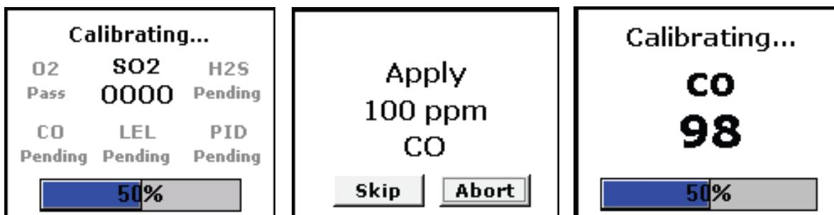
Nakon završetka kalibracije, sledeći ekrani prikazivaće uspešna (pass), na granici (marginal), preskočena (skipped), i greška senzora, kada je instalirano 6 senzora. Svaki senzor mora prvo da prođe podešavanje nule a zatim da prođe i kalibraciju.
