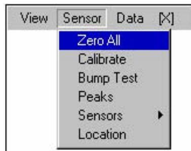
Ukoliko je CO<sub>2</sub> senzor prisutan u instrumentu, on se poslednji nulira. Nulti vazduh mora da bude doveden za upisivanje nule CO<sub>2</sub> senzora. Instrument izdaje nalog korisniku da primeni "nulti" vazduh. Obeležite OK taster. Ukoliko korisnik izabere OK taster, odpočinje upisivanje nule za CO<sub>2</sub> senzor.
