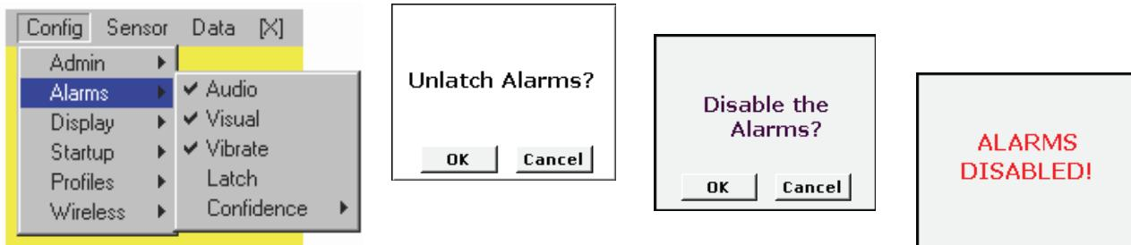
Ukoliko su sva tri alarma isključena, crveno "ALARMS OFF!" je prikazano na dnu u režimu normalnog očitavanja koncentracije gasa.
