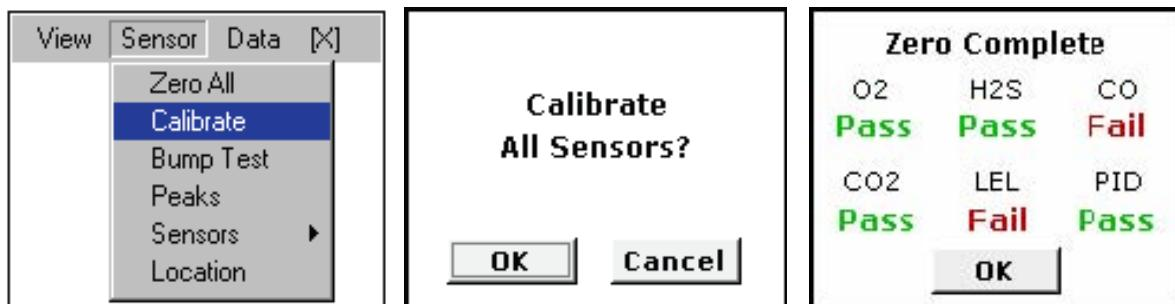
Ekran upozorava korisnika da primeni kalibracioni gas na instrument kako je to već predstavljeno. Jedan senzor odpočinje sa očitavanjem koncentracije gasa i kalibracija je odpočela. Korisnik ima 5 minuta da dovede kalibracioni gas u suprotnom kalibracija će biti prekinuta. Gas treba dovesti sa neophodnim protokom od 0.5 Lit/min. Ukoliko korisnik izabere da preskoči ovaj senzor, instrument će se pomeriti na naredni senzor. Opcija prekida (abort) prekida kalibraciju i prikazuje Cal Complet ekran.
