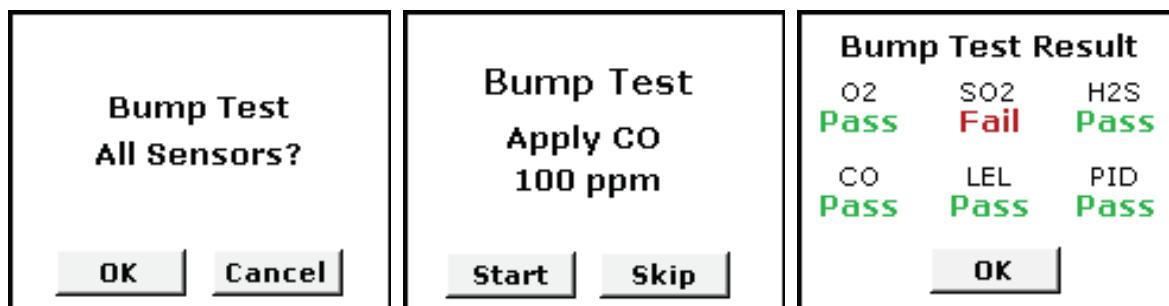
Ukoliko više od jednog senzora ne prođe “bump” test, oni će biti kalibrirani u redosledu (vrh reda levo na desno, dno reda levo na desno u normalnom režimu očitavanja), jedan po jedan – svaki put pitajući korisnika za izbor da li želi ili ne želi da kalibriše sensor.
