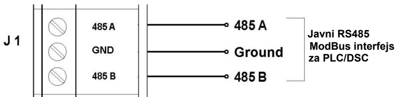
Slika 4-9 Dijagram povezivanja za ModBus Interfejs
