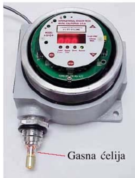
Slika 1. Primer IR gasnog monitora sa otvorenom gasnom ćelijom.
